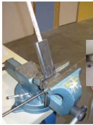
Cintrage avec griffe Nx et fer béton
