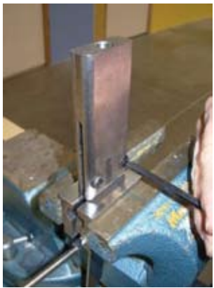
Cintrage avec griffe Nx et fer béton
